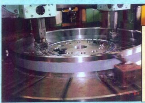
TURNING GEAR BEING MACHINED USING DOUBLE TOOL POST RAM.
